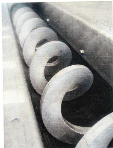
Sono costituite da una spira senza albero interno che ruota all'interno di un truogolo (tubolare o con sezione ad U), con una o più tramoggie di carico e una o più bocche di scarico. Il resto della macchina è chiuso da coperchi.
